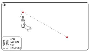
Effettuare i fori a soffitto/parete e inserire i tasselli ad espansione. Make the ceiling/wall holes and insert the expansion plugs.
