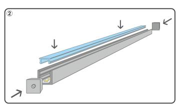
Applicare i tappi e se richiesto fissarli con le viti in dotazione, quindi inserire la copertura. Il tappo aperto è predisposto per l'uscita del cavo di alimentazione.
