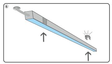
Agganciare il profilo con una leggera pressione. Hook the profile with a slight pressure on.
