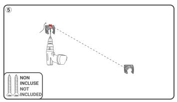
Posizionare le mollette ed installarle con le apposite viti. Position the clips and install them with the appropriate screws.
